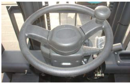
較小的方向盤直徑從360mm縮至300mm可使操作者減少疲勞。
