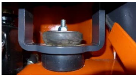
機身與底盤間的4個橡膠阻尼器使震動最小化，保護駕駛者的腰椎。
